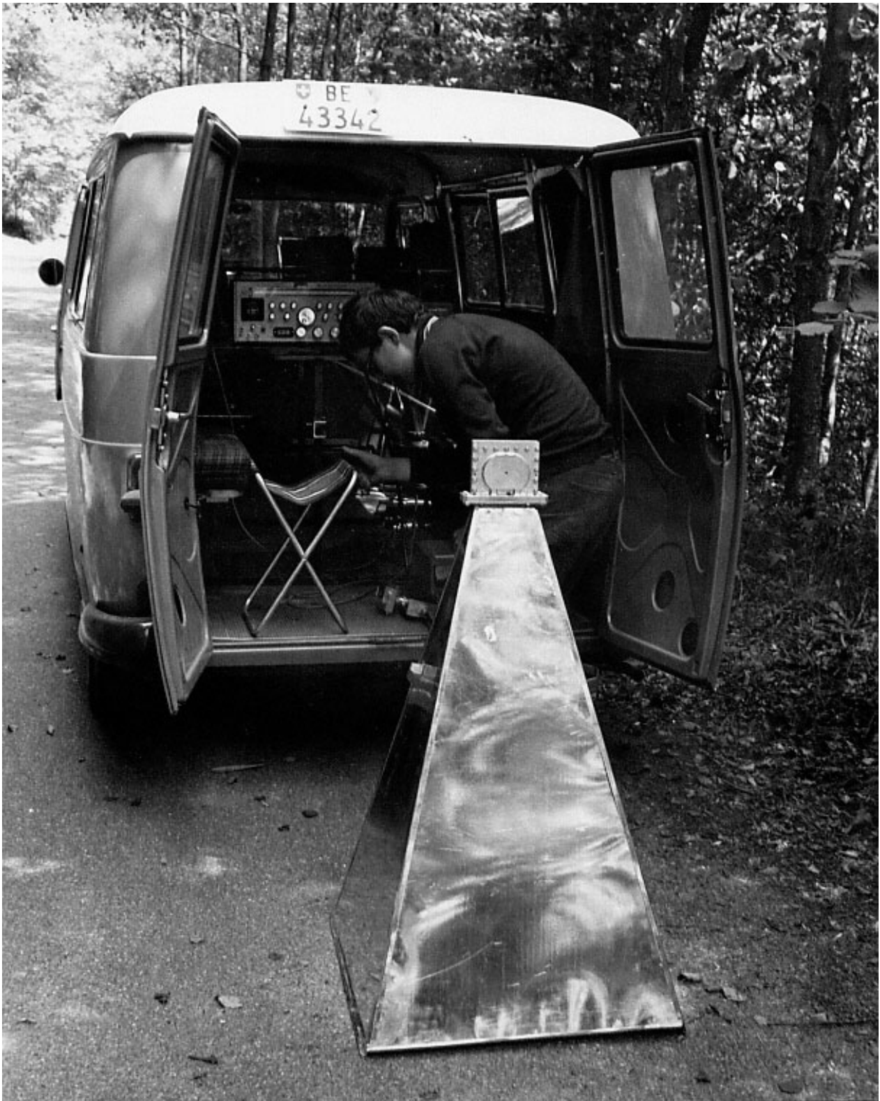
Figur 6. Messwagen und die speziell für die Messung angefertigte Hornantenne.
